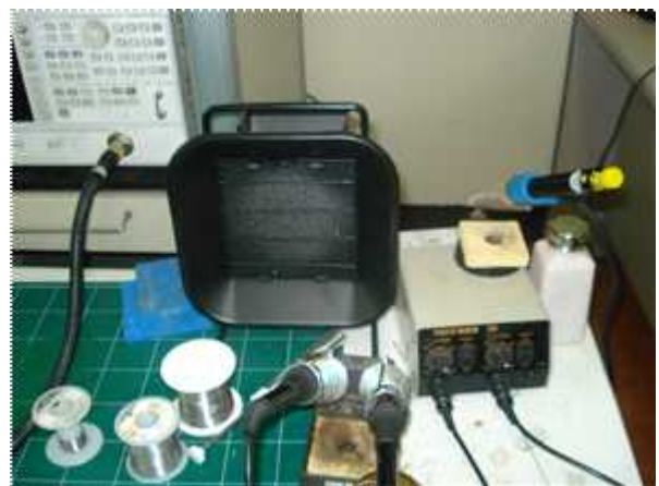
납흡 제거장치 설치
